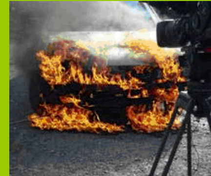
Deutsche Umwelthilfe tests the flammability of HFO1234yf. (23.10.08)
