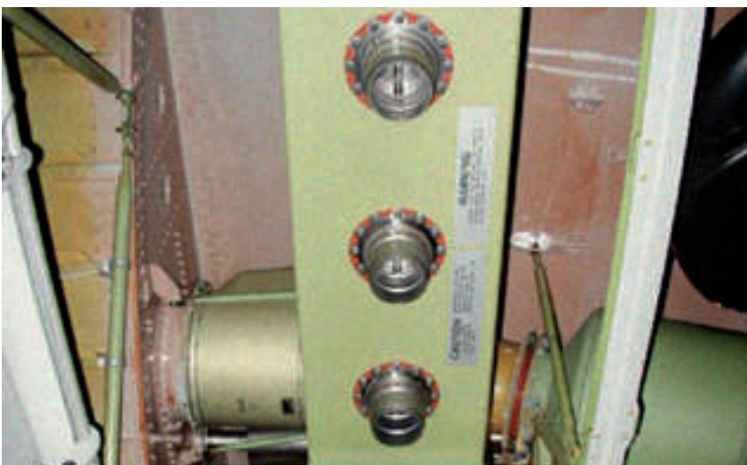
Meerdere grondaansluitingen achter een luik onder de romp.
